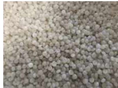
Extruderen, granuleren Grondstof voor nieuwe producten
